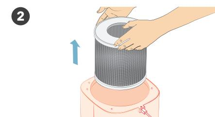
空気清浄機のコンセントを抜きます。古いフィルターを取り外し、適切に処分してください。
