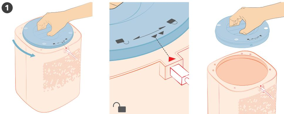
空気清浄機を逆さまにして、フィルターカバーを回して
