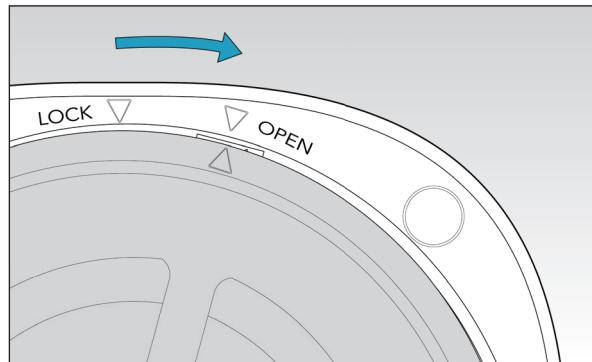
3. 古いフィルターを取り出し、新しいフィルターを設置します。
